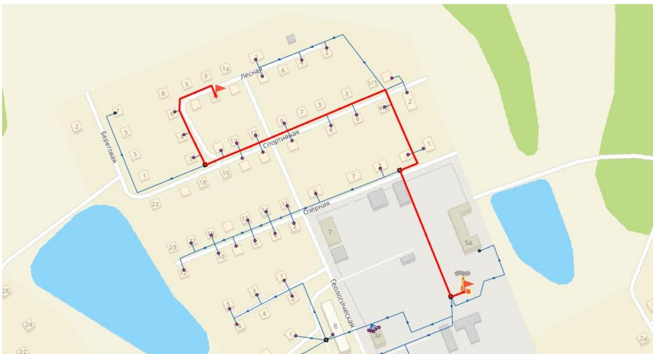
Рисунок 3.13 – Путь теплоносителя по направлению от котельной ж/д ст. Мочище по ул. Геологическая, 5б до потребителя по ул. Лесная, д.12
