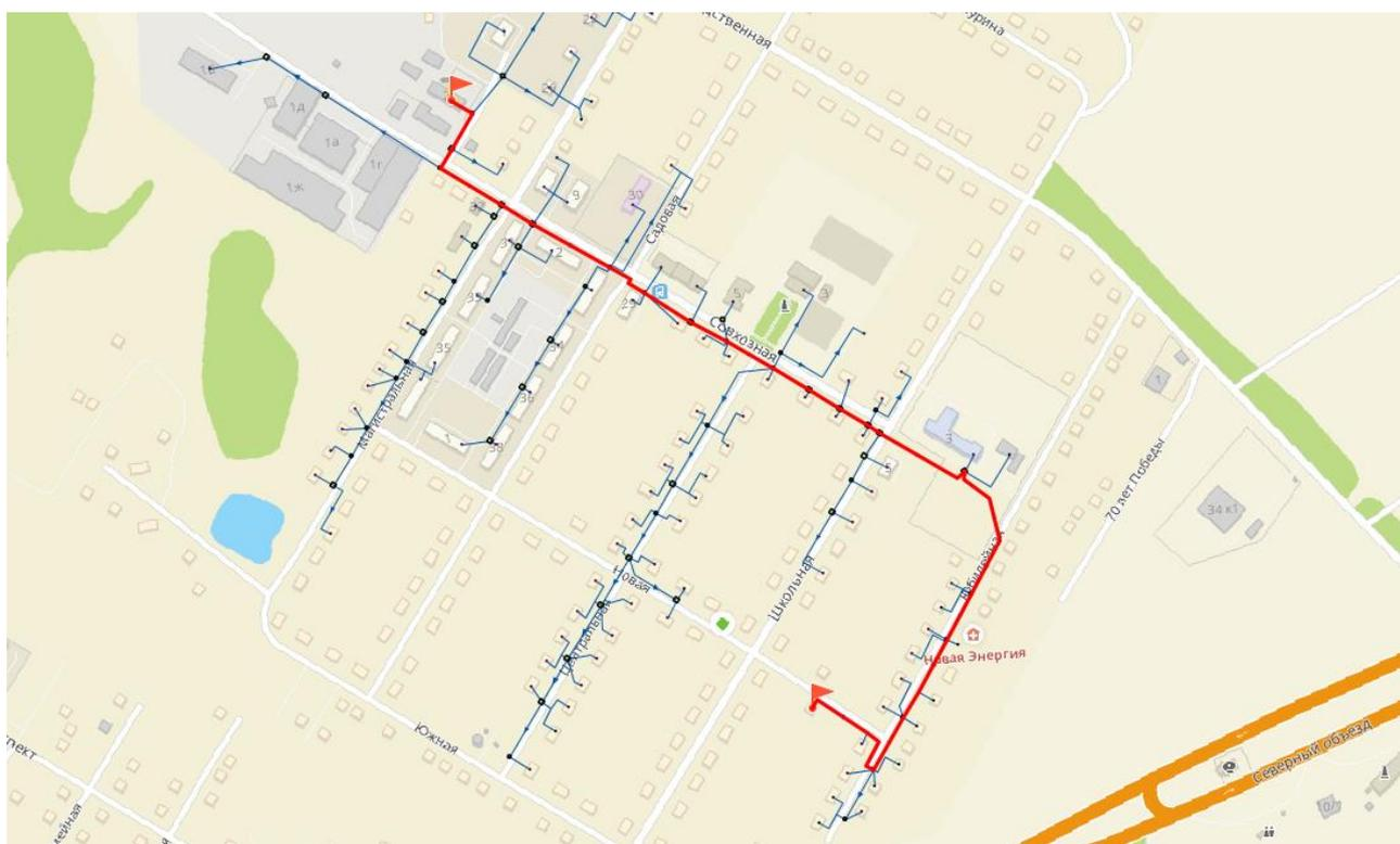
Рисунок 3.9 – Путь теплоносителя по направлению от котельной пос. Садовый по ул. Короткая, 2 до потребителя по ул. Новая, 14.
